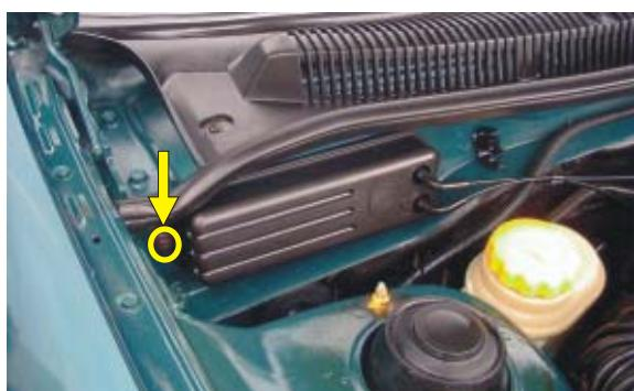
(PL) Odkręcić śrubę mocującą pokrywy filtra
